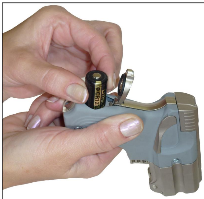
Рисунок 13 – Верное положение батареи
