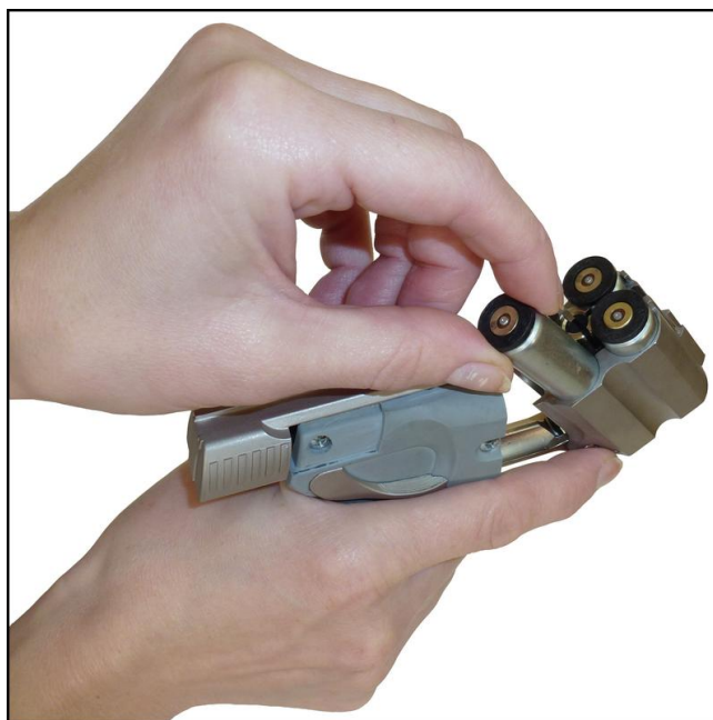
Рисунок 6 – Установка патронов в кассету
